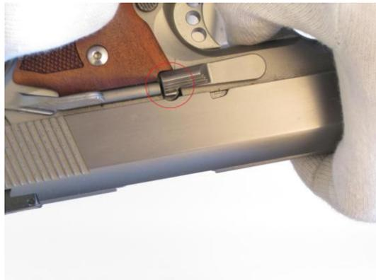
3. Entfernen Sie den Schlittenfanghebel so, dass die Erhöhung des Hebels unter der halbmondförmigen Auskerbung im Schlitten herausgedrückt wird und ziehen Sie den Schlitten nach vorne aus dem Griffstück.
