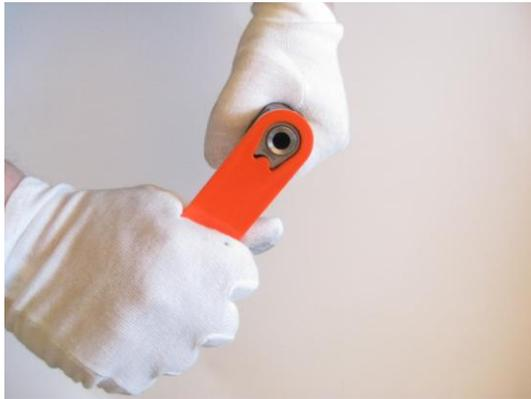
8. Beim Justieren des Bushings muss der Hülsenmund der Federführungshülse in der Aussparung des Bushings sitzen. Das ist sowohl für die Funktion als auch für die Präzision extrem wichtig.
