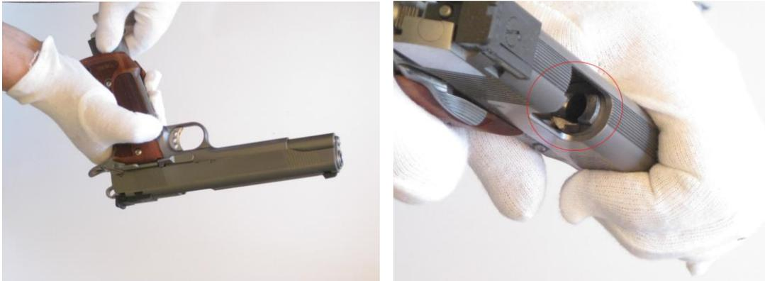
2. Ziehen Sie den Schlitten nach hinten, bis sich der Schlittenfanghebel unter der halbmondförmigen Schlittenaussparung befindet.
