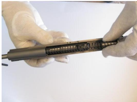
6. Setzen sie den beiliegenden „Bushing-Schlüssel“ so an, dass er das Bushing fest umschließt und drehen es eine Achtelumdrehung weiter gegen den Uhrzeigersinn. Sie können nun den Lauf mit dem Bushing und der Hülse nach vorne aus dem Schlitten herausziehen.
