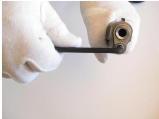
5. Ziehen Sie den hinteren Teil der Stange mit der Feder nach hinten aus der Hülse. Beachten Sie, dass die Feder unter Spannung steht.
