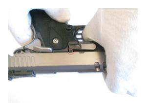
3. Entfernen Sie den Schlittenfanghebel so, dass die Erhöung des Hebels unter der halbmondförmigen Auskerbung im Schlitten herausgedrückt wird und ziehen Sie den Schlitten nach vorne von dem Griffstück.
