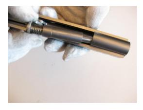
7. Drücken Sie den Lauf leicht aus der Verriegelung und ziehen ihn nach vorne aus dem Schlitten.
