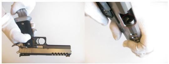
2. Ziehen Sie den Schlitten soweit nach hinten bis die halbmondförmige Schlitten-Aussparung über dem Schlittenfanghebel ist.
