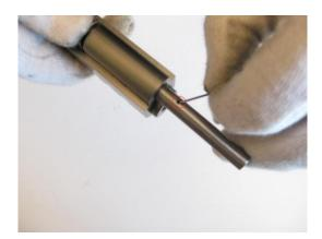
6. Lassen Sie die Federführungsstange langsam nach hinten gleiten, bis der Stift gegen die Hülse stößt. Sie können nun die gesamte komprimierte Federeinheit nach hinten aus dem Schlitten ziehen.
