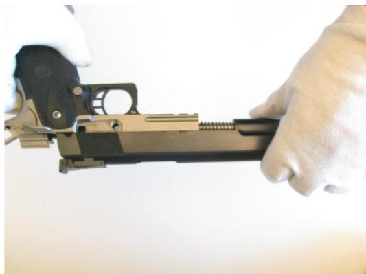
4. In der Federführungsstange ist vorne eine Inbus-Öffnung. Schrauben Sie mit dem beiliegenden Inbus-Schlüssel die Federführungsstange auseinander. Drücken Sie das Ende der Federführungsstange mit der anderen Hand von unten gegen den Lauf, damit sich dieses Teil der Stange nicht mitdreht.
