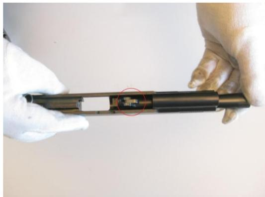
7. Setzen Sie die Waffe in umgekehrter Reihenfolge zusammen. Die Schließfederhülse hat hinten einen überstehenden Rand. Drehen Sie die Hülse beim Zusammensetzen so, dass dieser Rand in der Vorderkante des Schlittens ist.
